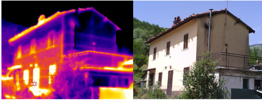
Figura 12- Esempio di termografia eseguito su un edificio residenziale
