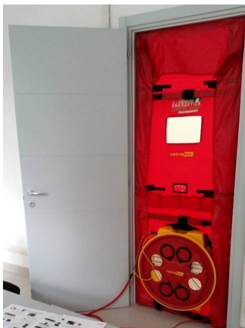
Figura 13- Esempio analisi tramite Blower door test
