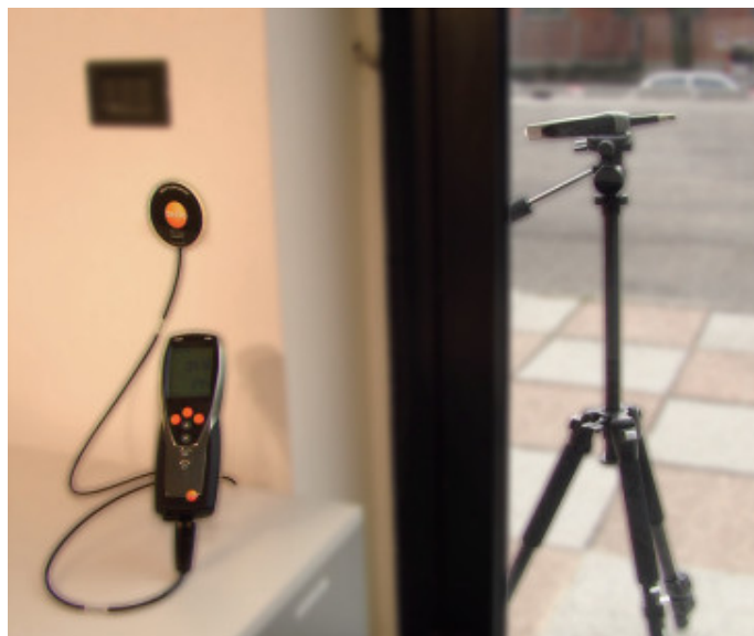
Figura 14- Esempio di indagine con termoflussimetro (fonte: www.testo.com )
