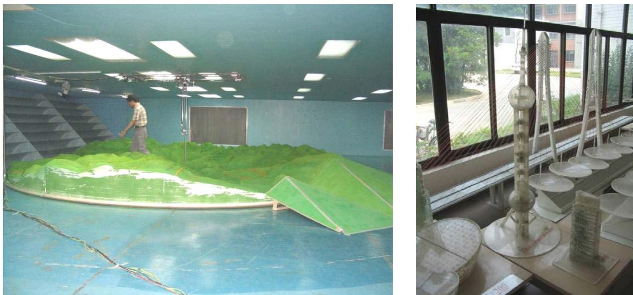
Figura 2.3. L'interno di una galleria del vento per l'ingegneria civile (foto a sinistra) e modelli in scala dotati di sensori per la misura delle pressioni del vento (foto a destra)
