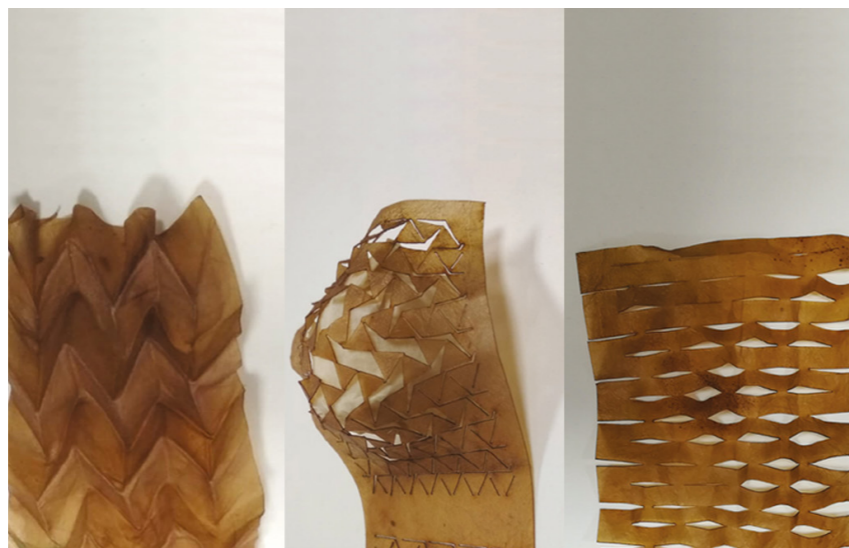
Fig. 6. Growing Experiment: textures, Lorena Trebbi e Chiara Del Gesso, 2019, campioni di nanocellulosa batterica con texture auxetiche e Miura-ori folding.
