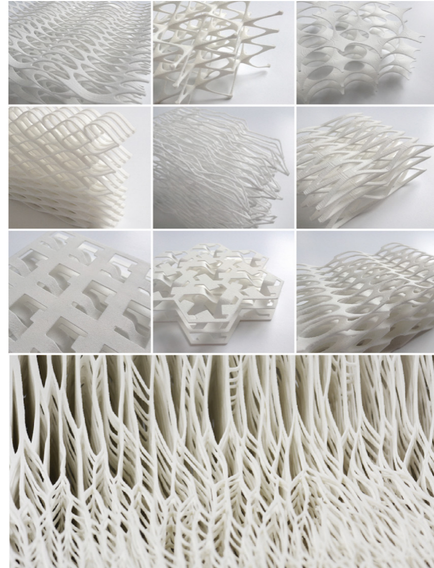
Fig. 4. Biomimicry Chair, 2014. Test sperimentali dell'evoluzione strutturale della seduta stampata in 3D con materiale bio-degradabile. Lilian van Daal®.
