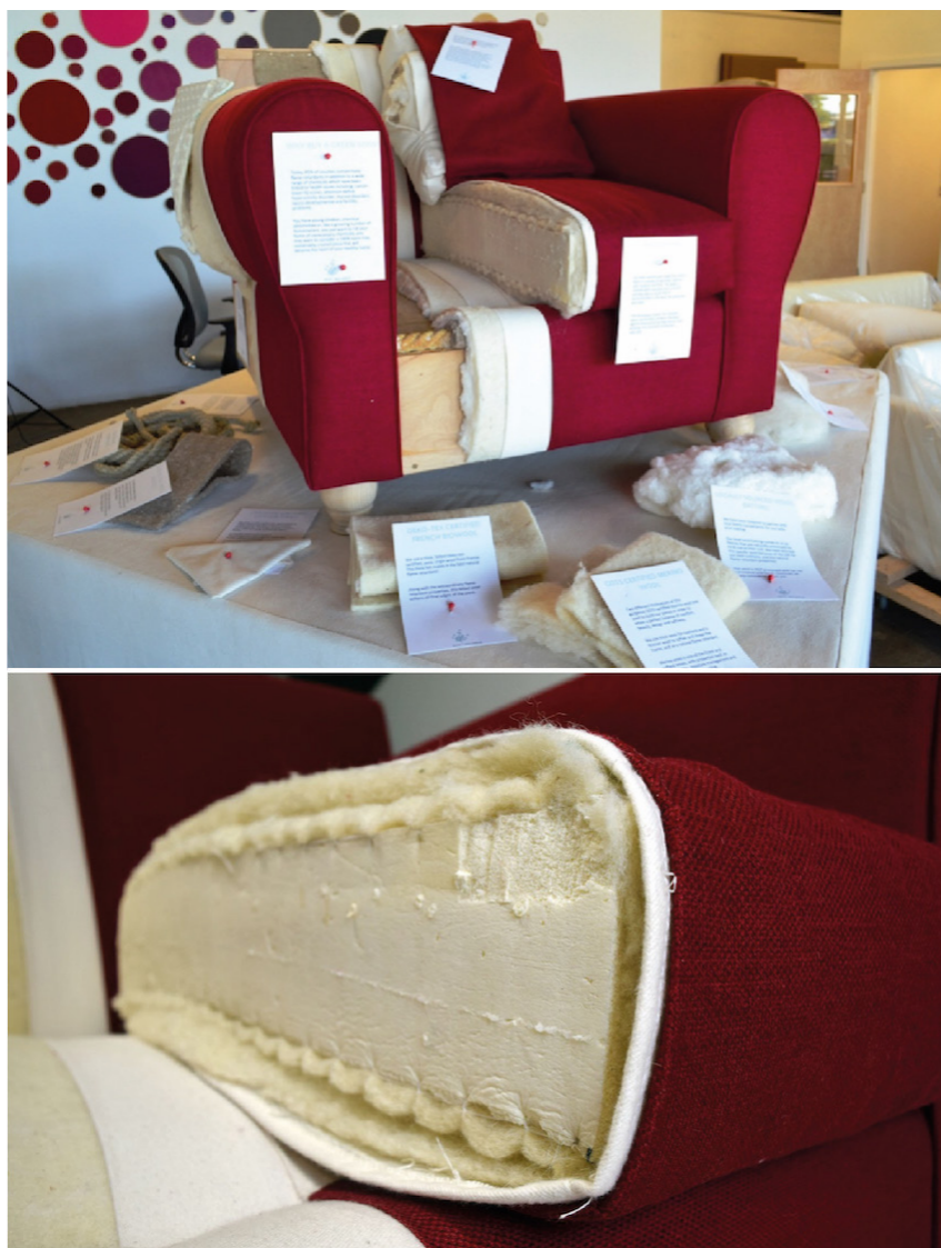
Fig. 5. Poltrona EcoBalanza, 2015. Modello esemplificativo dei processi di produzione e dei materiali certificati ambientalmente utilizzati per la produzione di una linea di sofà e divani sostenibile a ciclo di vita. EcoBalanza®.
