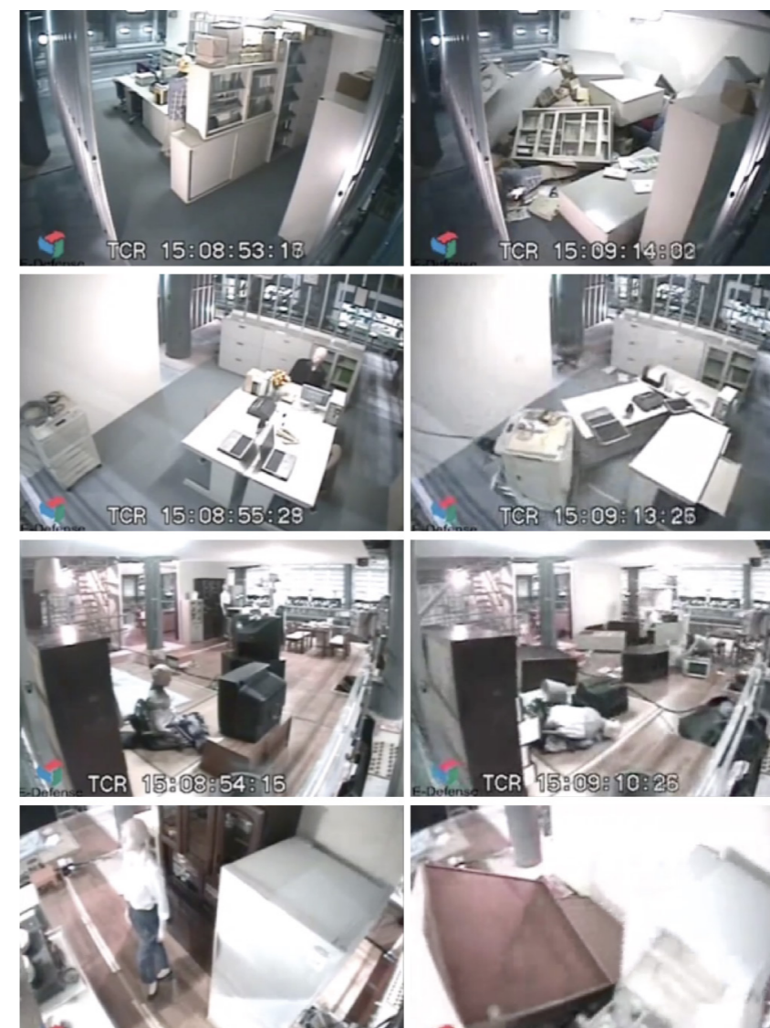
Fig. 2. Hyogo Earthquake Engineering Research Center, 2015. Test su tavola vibrante di elementi non strutturali, © E-Defense Japan.
