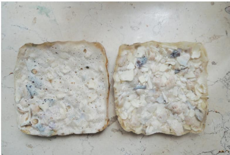
Figura 4 Biocomposito ottenuto con gelatina in polvere (a sinistra) ed in fogli (a destra)
