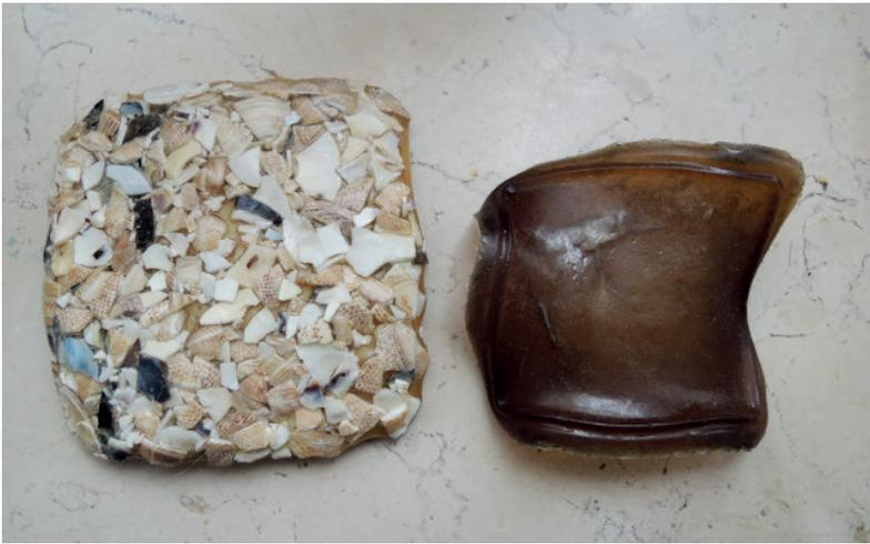
Figura 3 Biocomposito con frammenti di gusci di vongole (a sinistra) e sola matrice bioplastica (a destra)
