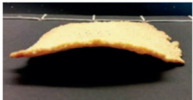
Figura 3 Prove di ritiro sulle bioplastiche. A sinistra: Provino di 10x10 cm con spessore circa 3 mm - Asciugatura in forno 60°C ventilato per 2 ore e tenuta in posa sotto pressione per circa 4 giorni. A destra: Provino di 10x10 cm con spessore circa 3 mm. Deformazione dopo 2 settimane
