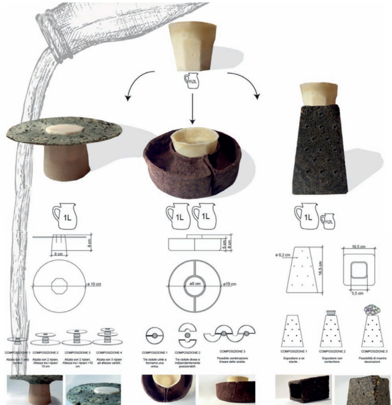
Figura 6 In alto: prototipi dei tre elementi. In basso: Disegni tecnici degli stessi con dettagli degli elementi
