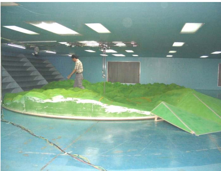
Figura 2.3. L'interno di una galleria del vento per l'ingegneria civile (foto a sinistra) e modelli in scala dotati di sensori per la misura delle pressioni del vento (foto a destra)
