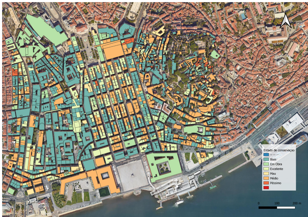
Fig. 8. Stato di conservazione degli edifici del centro storico di Lisbona (fonte: Camara Municipal de Lisboa)
