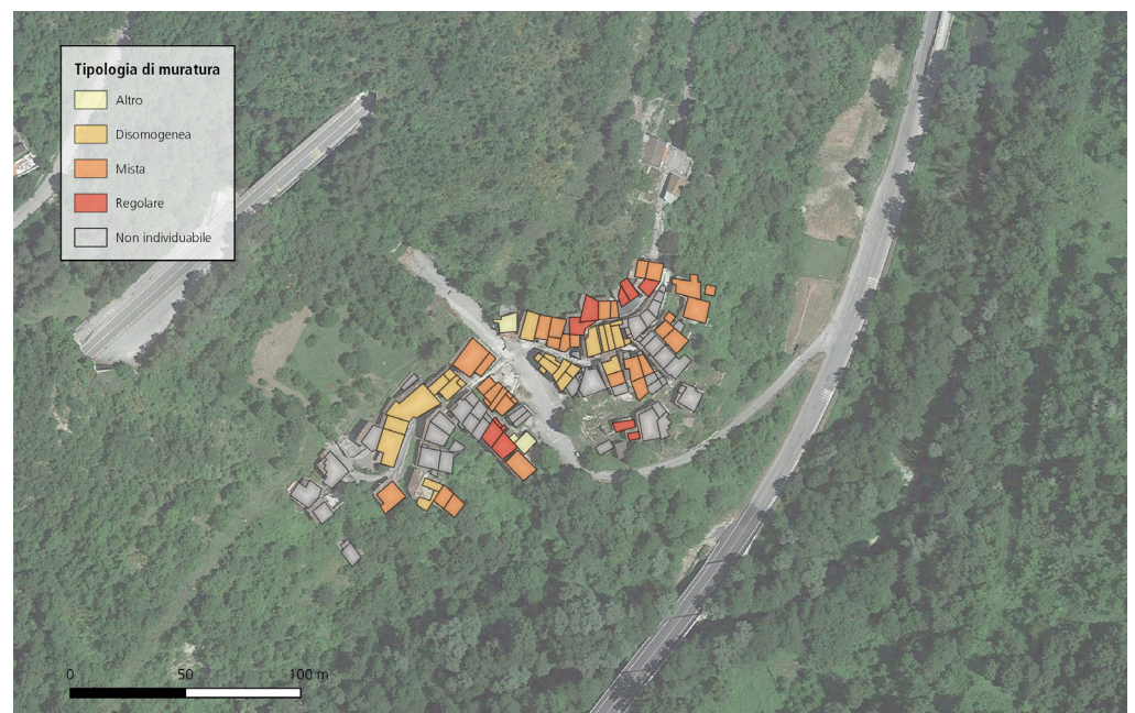
Fig. 8. Tipologia di muratura riscontrata nel centro storico di Vezzano
