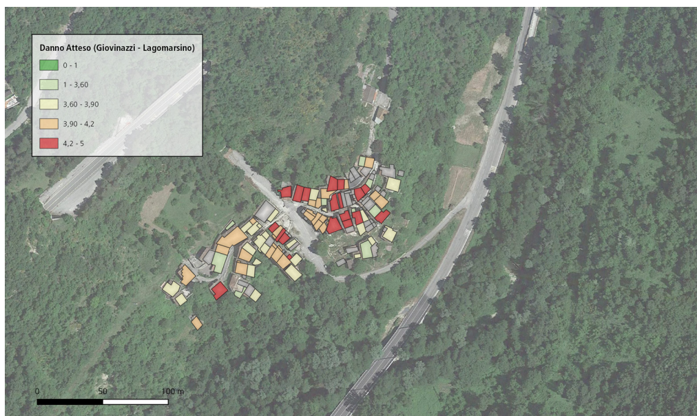
Fig. 18. Danno atteso attraverso Indice di Vulnerabilità calcolato secondo il metodo Polese et al. (2020)
