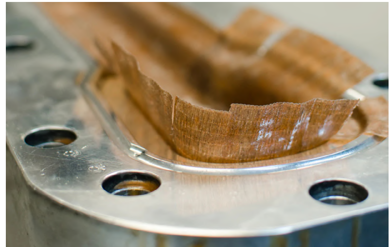
[fig. 03] Laminazione di una chitarra Blackbird El Capitan. Fonte: Bio-prepreg guitar – The look, feel and acoustic quality of wood
