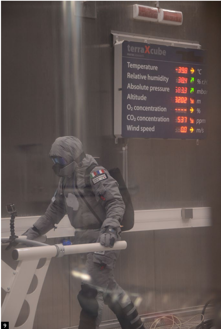
Antartica. Fasi di test della tuta in camera climatica a -70 °C percepiti e 3220 m s.l.m.
