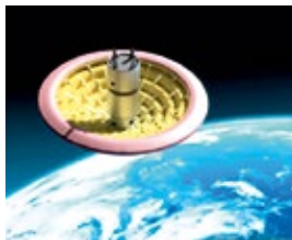
Fig. 22 - Sistema prototipale di HIAD: Hypersonic Inflatable Aerodynamics Decelerator
