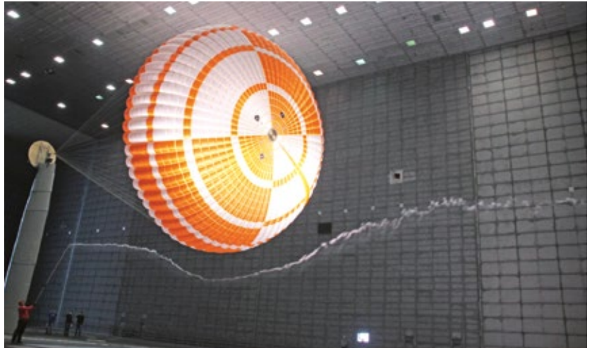
Fig. 30 - Il prototipo di paracadute in scala 1/3 durante i test in galleria del vento. Credit NASA
