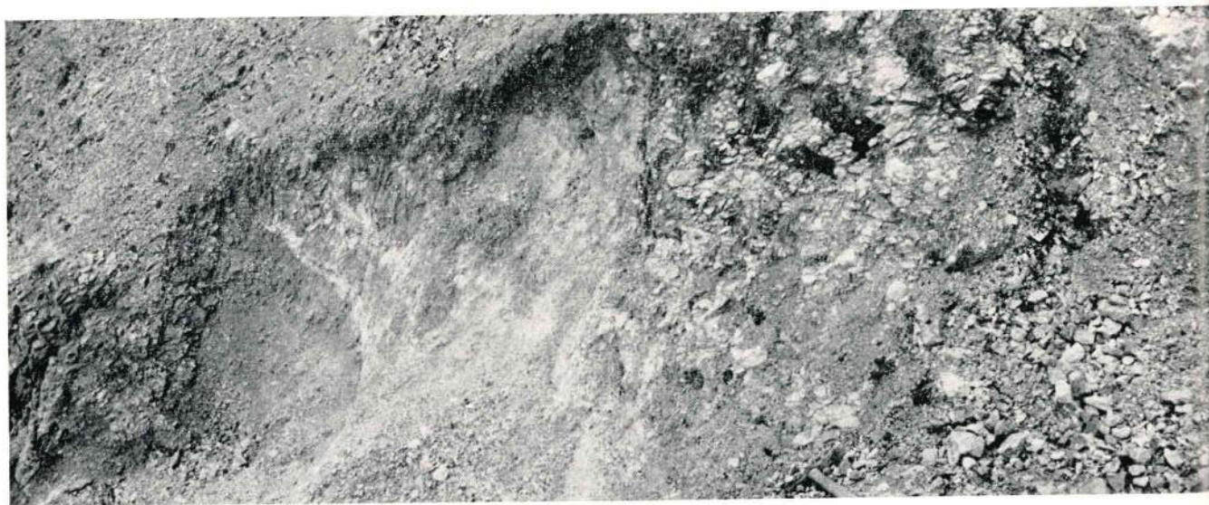
Fig. 6 - novembre 1959 - Lo scavo di cui alla figura 5, con le miloniti che separano gli strati a giacitura discordante, rispettivamente della parete (conglomerato del livello b , visibile a destra) e del basamento in posto (roccia frantumata a sinistra).
