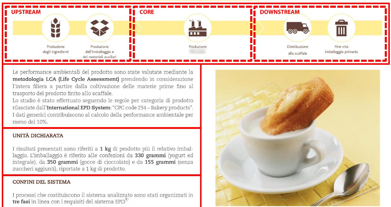
Fig. 14 Esempio di Environmental Product Declaration (EPD): la definizione dei confini del sistema valutato e la dichiarazione delle unità di misura. Fonte: Azienda caso studio, 2020
