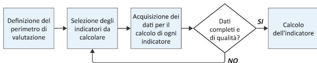
Fig. 32 Flusso di acquisizione dei dati per il calcolo degli indicatori della UNI/TS 11820. Fonte: Ente Normativo Italiano UNI, 2022
