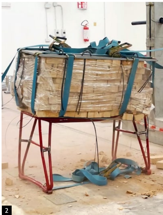
2 Test di impatto per verificare la resistenza dei banchi in caso di crolli parziali della struttura durante un terremoto.
