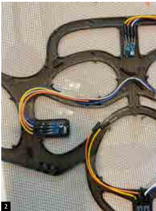
2 Maschera Smart plenifacciale tipologia C composta da un framelayer realizzato in biopolimero e sistema Medical IoT con sensori di umidità, di qualità dell'aria e pulsossimetro.
