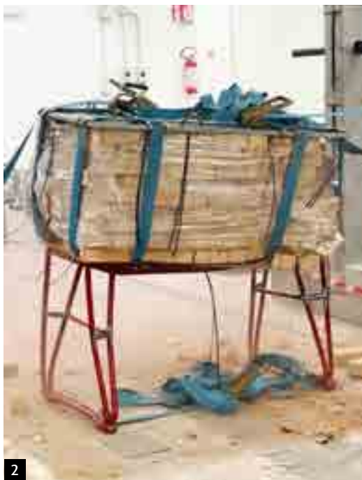
Test di impatto per verificare la resistenza dei banchi in caso di crolli parziali della struttura durante un terremoto.
