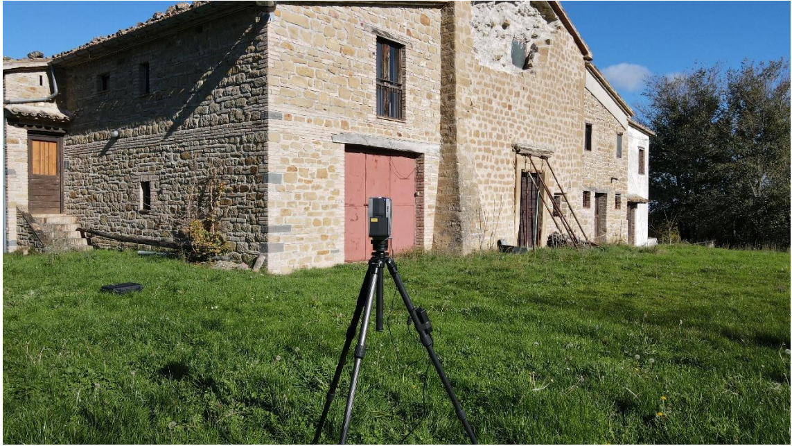
Figura 41 - Ripresa fotografica durante il rilevamento con il laser scanner Faro Focus X 130
