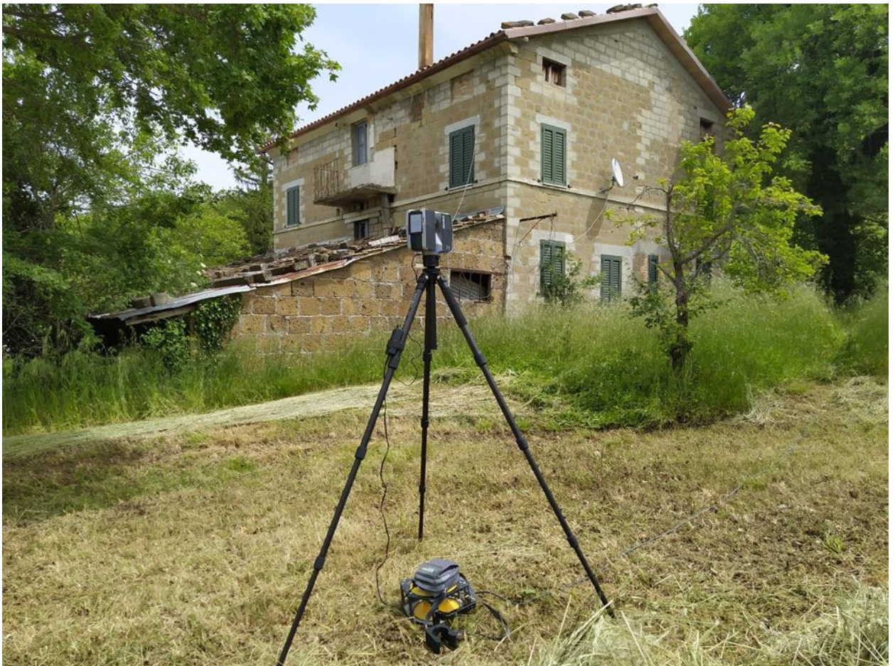
Figura 18 - Processo di acquisizione di informazioni tridimensionali
