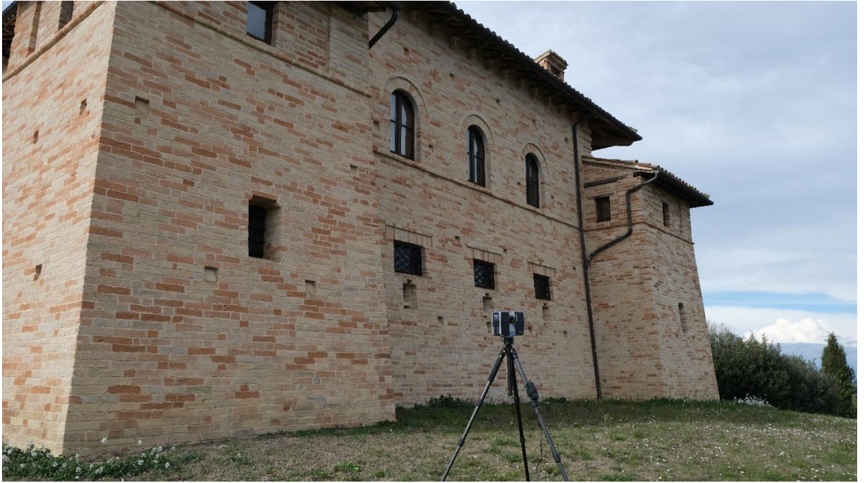
Figura 61 - Ripresa fotografica durante il rilevamento con il laser scanner Faro Focus X 130
