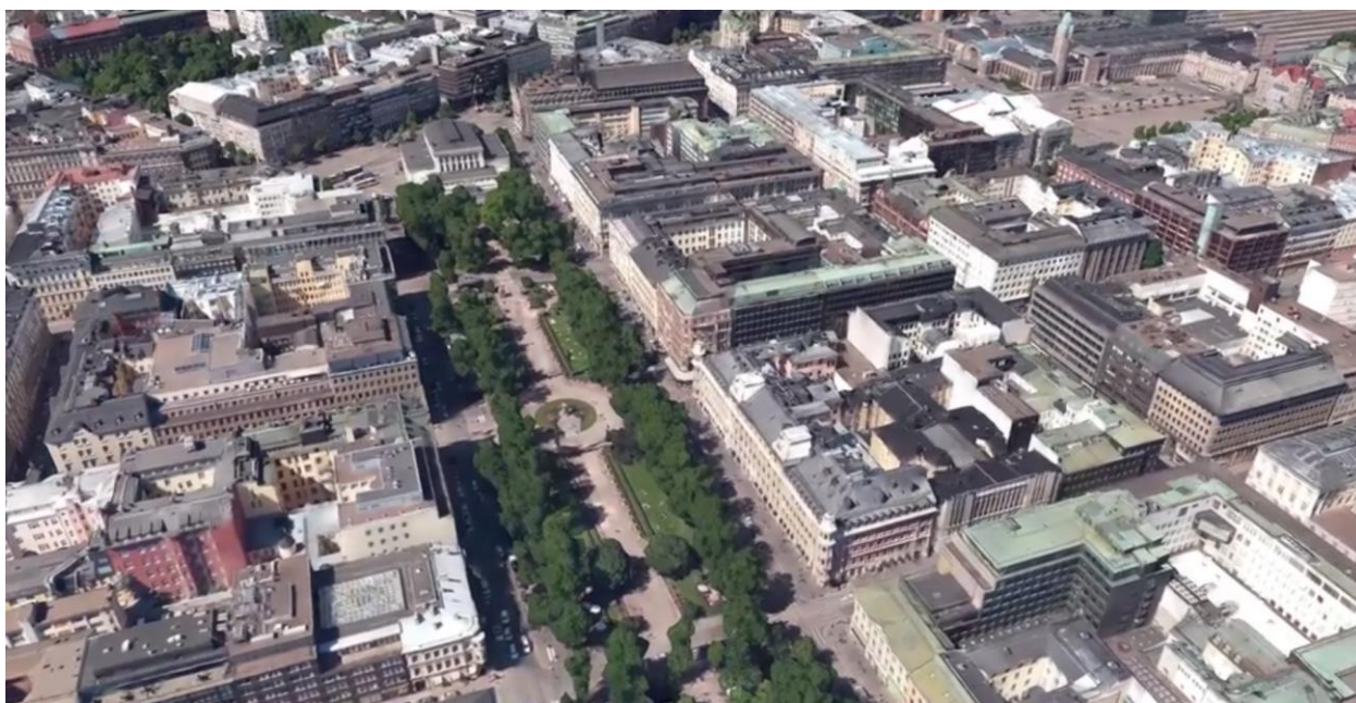
Figura 129 - Combinazione di una nuvola di punti e un modello BIM, città di Helsinki 64
