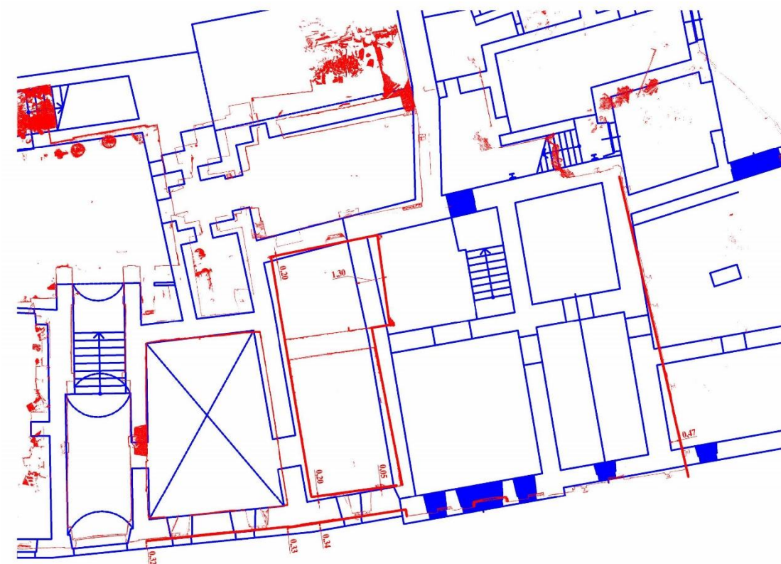
Figura 57 – Sovrapposizione delle planimetrie disegnate in CAD con la nuvola di punti del Borgo
