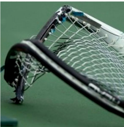
fig. 02 Rottura fibra di carbonio
