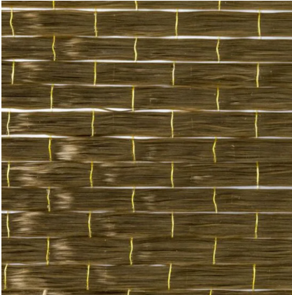
fig. 28 Fibra di basalto. Origine minerale
