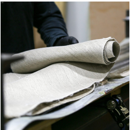
fig. 03 "Pelli" pronte per la laminazione
