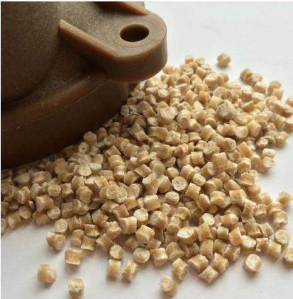
fig. 04 Compound di PLA con fibre di canapa
