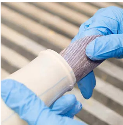
fig. 03 Jet Aviation ha iniziato a utilizzare una resina di origine biologica nella produzione di parti composite per gli interni delle cabine degli aerei
