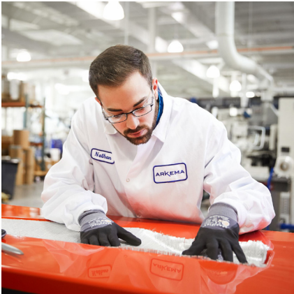
fig. 04 Una fase di applicazione della resina termoplastica, e riciclabile, Elium®, brevettata da Arkema
