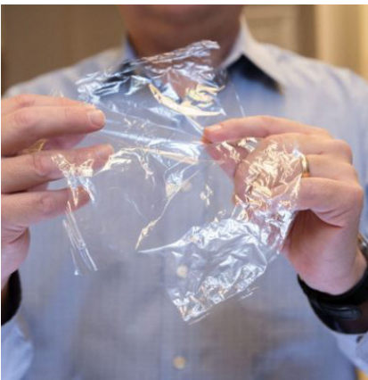
fig. 01 Bioplastica costituita da cellulosa e chitina che potrebbe sostituire i convenzionali imballaggi in plastica flessibile
