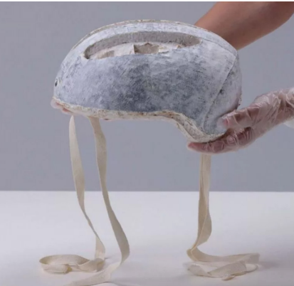
fig. 08 Caschi per bicicletta a base di fiocchi di canapa e micelio
