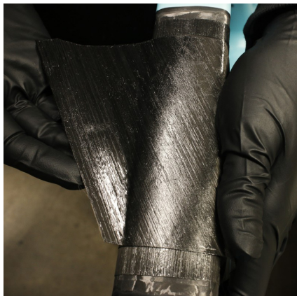
fig. 01 Riparazione telaio bici, by Ruckus
