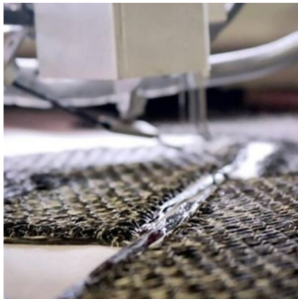
fig. 07 Tailored Fiber Placement (TFP): Posizionamento preciso di fibre per strutture composite ottimizzate
