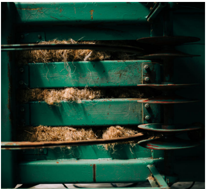
fig. 18 Virgocoop, dettaglio impianto di stigliatura, in funzione dal 2024
