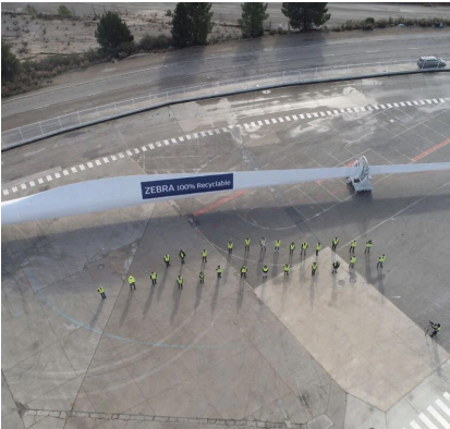
fig. 06 Primo prototipo di pala eolica con matrice riciclabile, 2023
