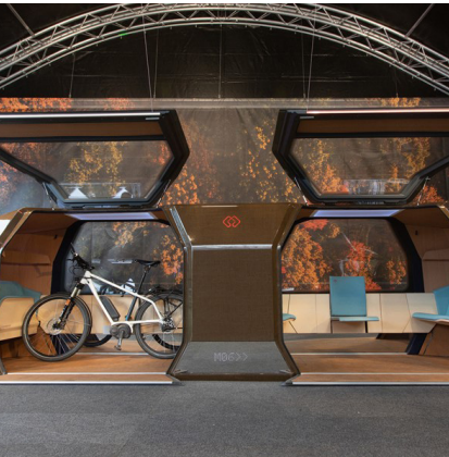
fig. 35 MONOCAB, cabina iper leggera progettata con compositi in fibra di canapa e scarti di sughero
