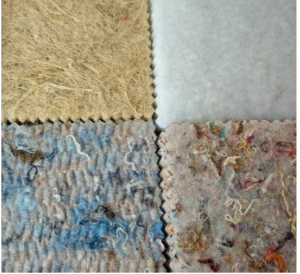
fig. 43 Isolkenaf: composto da fibre di kenaf, carta riciclata e fibre di PES
