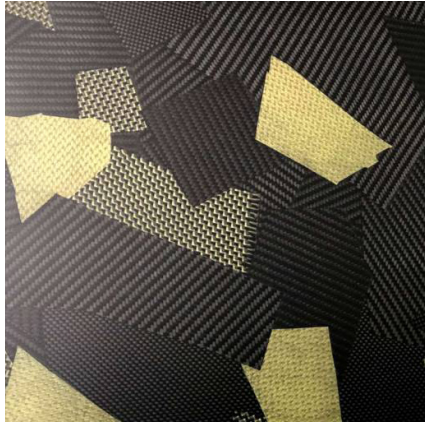
fig. 02 Raimante: materiale che riusa gli sfridi della laminazione dei compositi
