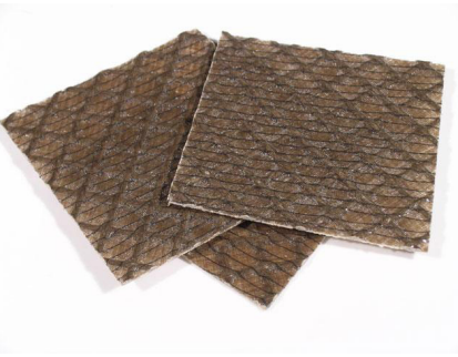
fig. 13 Campioni di fibra di lino immersa in bioresina termoindurente
