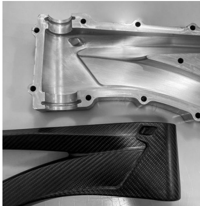
fig. 15 Telaio bici ottenuto per RTM
