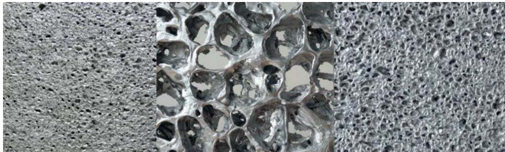
Figura 4. Schiuma di Aluminio Alusion con differenti gradi di permeabilità alla luce
