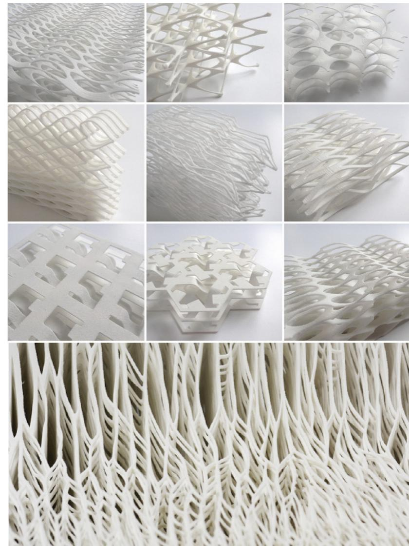
*Fig. 4. Biomimicry Chair, 2014. Test sperimentali dell'evoluzione strutturale della seduta stampata in 3D con materiale bio-degradabile. Lilian van Daal®.*
