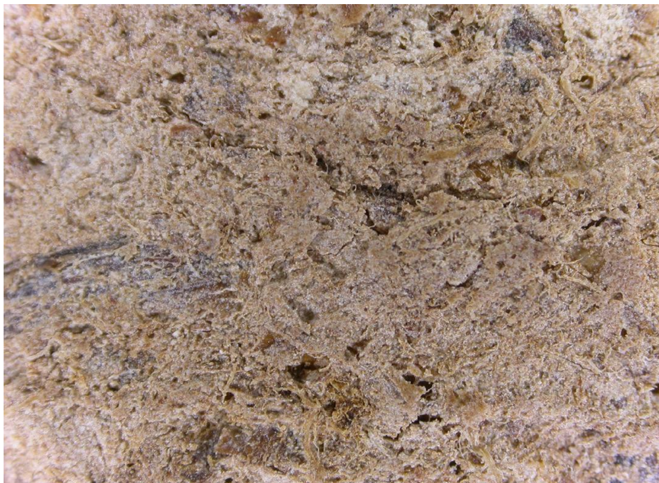
Figura 2 Aspetto della bioplastica al microscopio ottico digitale (40x)
